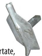
**1. Corpul ancorajului:** o piesă metalică lată ce constituie partea activă a ancorajului și o articulație cu un grad de libertate, de aproximativ 120° atașat în centrul de greutate al corpului ancorajului. Corpul metalic cât și articulația sunt din oțel protejat la coroziune prin zincare termică sau aluminiu (în cazul unor ancoraje Duckbill).
