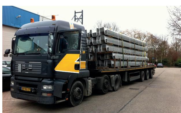
Un camion poate transporta între 16 și 20 tone de material. Aceasta reprezintă între 600 și 1200 metri<sup>2</sup> de palplanșe din PVC și numai între 110 și 220 metri<sup>2</sup> de palplanșe din oțel.
