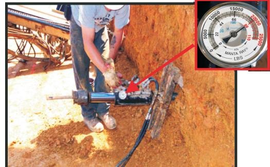
**7. Echipamentul de tragere:** Aceasta este folosit pentru a aduce ancorajul în poziție de lucru și poate fi: mecanic, mai exact o pârghie de gradul trei unde forța activă este dată de un cric hidraulic sau cu piston și pompă de ulei (pentru forțe ce depășesc 25kN). De subliniat că ambele tipuri de echipamente sunt prevăzute cu manometre fapt ce permite în orice moment măsurarea forței de tragere.
